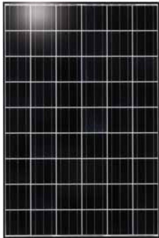
Modul: 54 Zellen = 24 V DC, Leerlaufspannung 29 V DC
